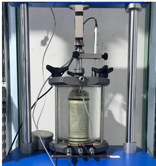
Рис. 2. Прибор трехосного сжатия мерзлых грунтов
